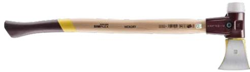
Maillet et hache à fendre en un outil, lame en acier au carbone forgé, trempé et revenu, rectifiée et polie, avec manchon de protection du manche massif, embout en superplastique, certifié KWF, toutes pièces échangeables
