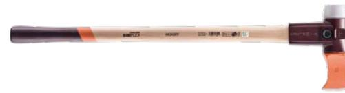
Maillet et masse merlin en un outil, lame en acier au carbone forgé, trempé et revenu, bec de piquage, embout superplastique, avec manchon de protection du manche massif, certifié KWF, toutes pièces échangeables
